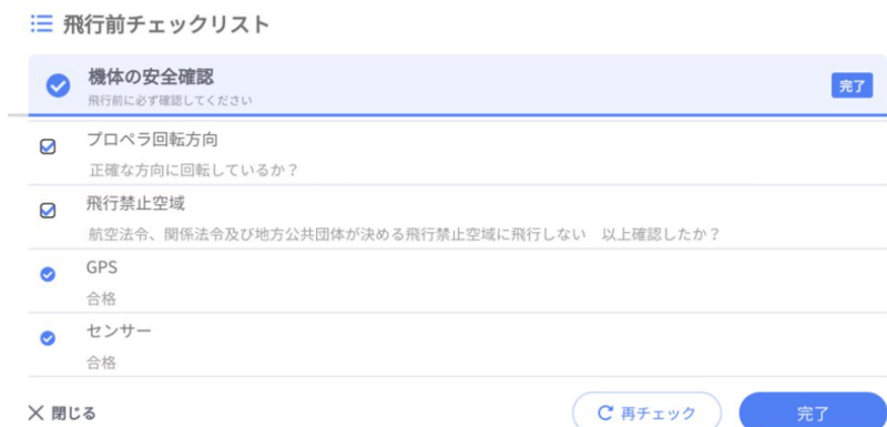
図 11 飛行前チェックリスト（完了状態）
