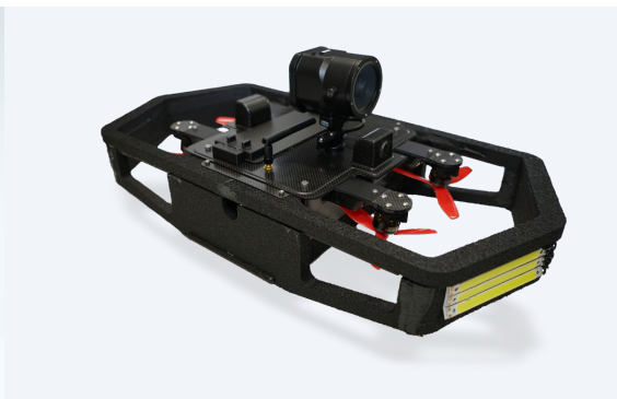
閉鎖環境点検 (Fi4)
